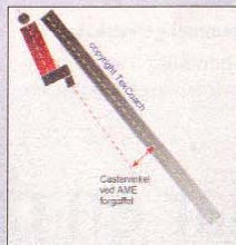
AME har udviklet et system, der flytter drejningsaksen ud af kronrøret, så castervinklen ikke ændres. Det giver samme lette køreegenskaber som ved en original forgæffel, da det runde kuglehovedleje i toppen af kronrøret er væsentlig mere letkørende end lejerne i kronrøret.
