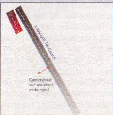
Monteres en lang forgæffel ved hjælp af standardmetoder, så øger man castervinklen, hvilket giver tungere styring og mindre stabilitet.
