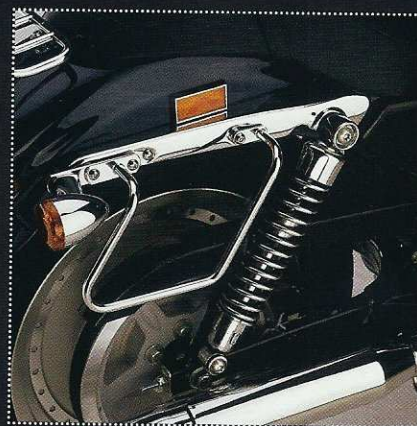
Packtaschenbügel „P“ mit Blinkerverlegung Baggage Holder „P“ movable turn lights
